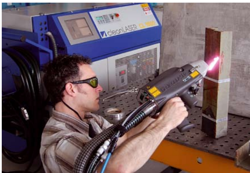
Mit der Energie des Laserlichts lassen sich Oberflächen schonend reinigen und umweltfreundlich entschichten.
