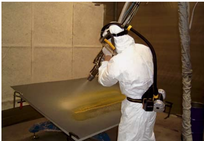
Über einen Sprühkopf wird schnell härtendes PUR in eine offene Form gesprüht – das Verfahren kommt ohne Styrol und Lösungsmittel aus.
