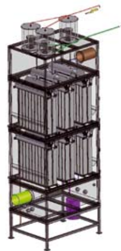
BEGA: Die Anlage reinigt Rohgas, hier Abluft, in einem Verfahrensschritt von Stäuben und Gerüchen.
