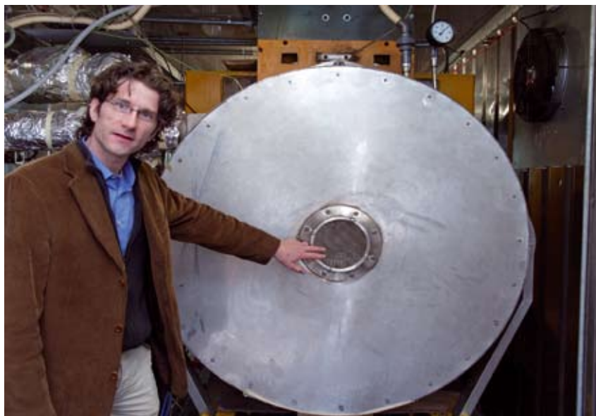
Das Flash-Pyrolyse Verfahren – an einer 600 Grad heißen Scheibe lässt sich aus Biomasse ein flüssiger Energieträger herstellen.
