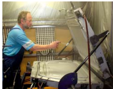
Klassische Kunststoffverarbeitung: Der Facharbeiter reinigt die Polyurethan-Spritzform.
