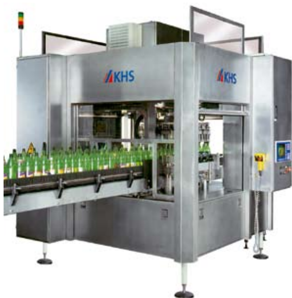
Das mit UNISENSOR-Technologie ausgestattete Sniffersystem KHS INNOCHECK FS kontrolliert bis zu 50.000 PET-Mehrwegflaschen pro Stunde auf Verunreinigungen.
