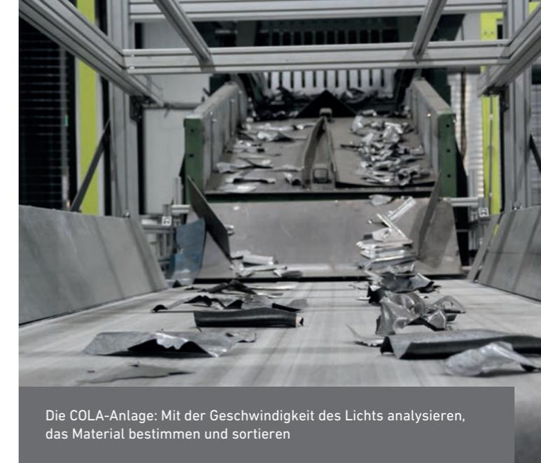
Die COLA-Anlage: Mit der Geschwindigkeit des Lichts analysieren, das Material bestimmen und sortieren
