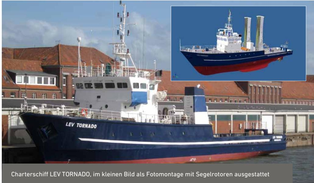
Charterschiff LEV TORNADO, im kleinen Bild als Fotomontage mit Segelrotoren ausgestattet
