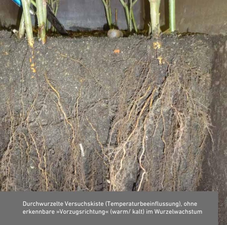
Durchwurzelter Versuchskiste (Temperaturbeeinflussung), ohne erkennbare »Vorzugsrichtung« (warm/ kalt) im Wurzelwachstum
